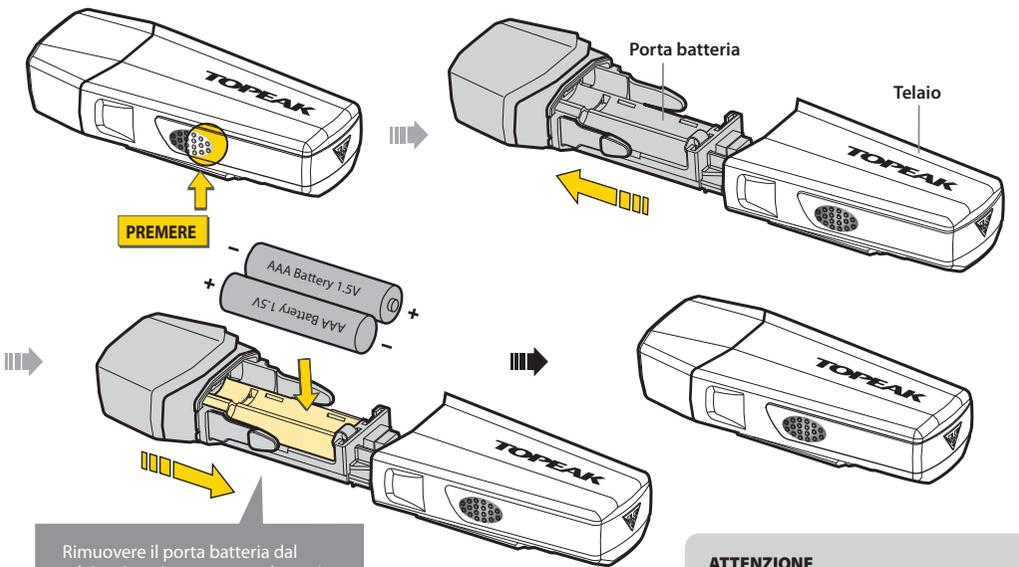
Rimuovere il porta batteria dal telaio e inserire una nuova batteria. Assicuratevi che la parte positiva e negativa della batteria siano installate correttamente.
